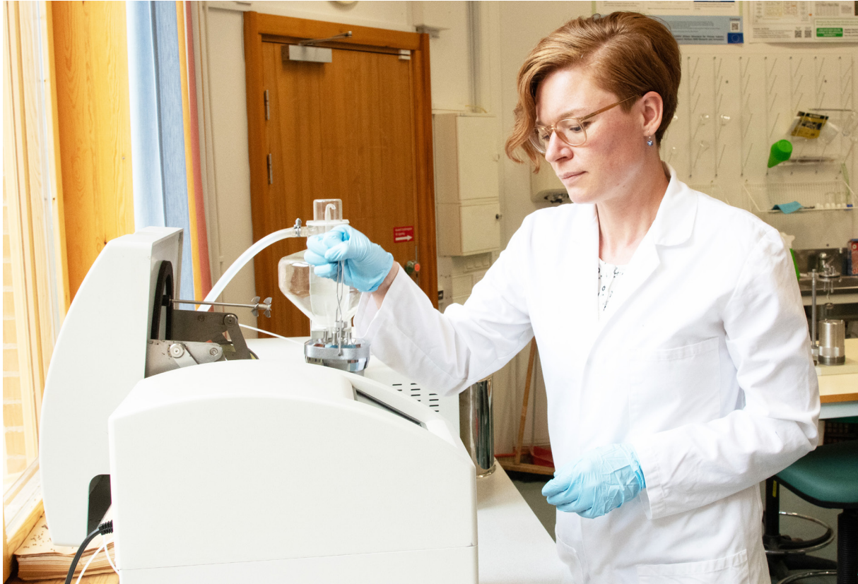
Ida Sylwan genomför analys av värmevärde hos slambiokol för underlag till energibalansberäkning.
